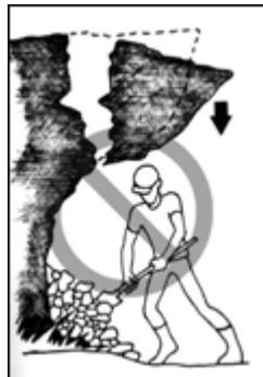
NO EXCAVAR POR DEBAJO, APUNTALAR O DERRUMBAR LA SECCIÓN INESTABLE
